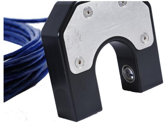
Le Détecteur de voile de boues **715** constitue une méthode simple et peu coûteuse de contrôle ponctuel du niveau de voile de boues dans une grande variété de bassins de décantation. L'enrouleur de câble élimine le besoin de tout sac de transport supplémentaire.
