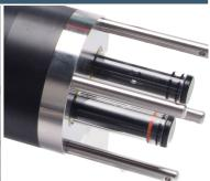
La sonde Turbi-Tech 2000 LA a été conçue pour une utilisation type dans les systèmes d'aération pour contrôler les boues recirculées mixtes, également connues sous le nom Boues activées, lorsque les matières solides sont typiquement dans une gamme de 1500 à 3500 mg/l. La sonde peut également mesurer le Retour de Boue Activée (R.A.S.), le Surplus Activé (S.A.S.), les Matières En Suspension ou la Turbidité dans n'importe quelle gamme d'application chargée.
