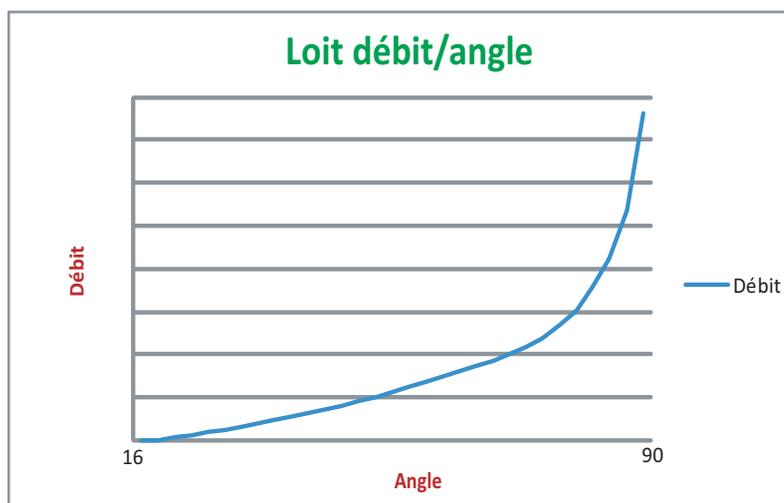
L'angle du battant est mesuré par rapport à la verticale. Clapet fermé l'angle est de 16°.
