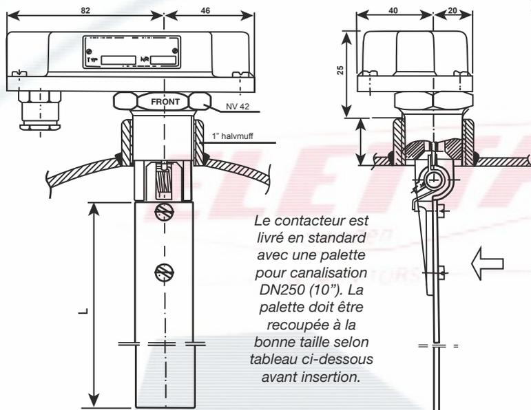
Le contacteur est livré en standard avec une palette pour canalisation DN250 (10"). La palette doit être recoupée à la bonne taille selon tableau ci-dessous avant insertion.
