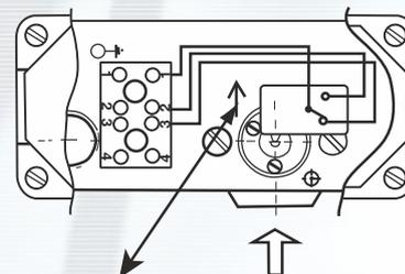
Lors de l'installation s'assurer que le sens du fluide est bien en conformité avec celui de la flèche de direction.
