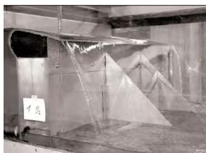
Seuil de mesure profilé **FluidWing®** pour écoulement laminaire sur seuils béton de surverse et mesure optimisée du débit -
