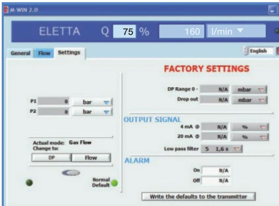
*Cette image est une copie d'écran montrant l'interface du logiciel M-WIN. Sur le côté gauche on peut voir les 3 modes de réglages. L'écran est sur le mode "Gaz", mais les modes "Pression différentielle" ou "Liquide" peuvent être sélectionnés par un simple clic !*
